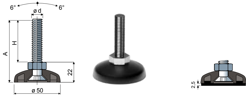
Maße der Spindel in Zoll / Mesures du tige en pouces
