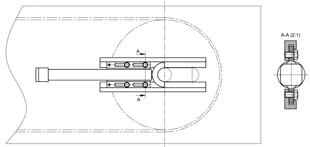
\_\_\_\_\_具"侧部连接"的 BIG TEN 弹性组件可用于设计在巨型链条或皮带输送机的从动轴中的挤压组件。弹性组件应安装在几块导向板上以便
