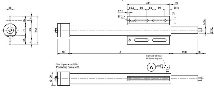
**材料** 外部结构、圆柱和弹簧均为钢制。滑动轴衬为铜制。
