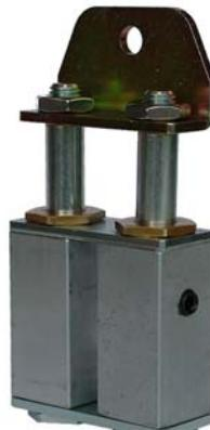
Spannelement mit zweifacher Säule. Die quadratischen Körper sind aus Aluminium realisiert; die Verbindungselemente, Säulen und Verschlüsse aus verzinktem Stahl. Die Bronzelager bestehen aus Messing. Das Spanneisen AFB ist mit einer Vorspannschraube (Schraube STEI (N) in den Größen 1 und 2; Schraube TE (Z) in der Größe 3) zur Vereinfachung der Montage versehen.
