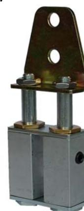
Spannlement mit zweifacher Säule. Die quadratischen Körper sind aus Aluminium realisiert; die Verbindungselemente, Säulen und Verschlüsse aus verzinktem Stahl. Die Bronzelager bestehen aus Messing. Das Spanneisen ist aus verzinktem Stahl. Das Spannlement ADB ist mit einer Vorspannschraube (Schraube STEI (V) in den Größen 1 und 2; Schraube TE (Z) in der Größe 3) zur Vereinfachung der Montage versehen.
