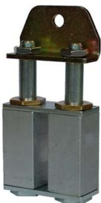
Spannelement mit zweifacher Säule. Die quadratischen Körper sind aus Aluminium realisiert; die Verbindungselemente, Säulen und Verschlüsse aus verzinktem Stahl. Die Bronzelager bestehen aus Messing. Das Spanneisen ist aus verzinktem Stahl.
