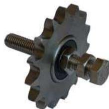
**XZK** Kettenräder sind aus Edelstahl (INOX) und auf Kugellager montiert. Idealer Einsatz für Einfach- Doppelt- und Dreifachkettentriebe, einer Geschwindigkeit bis zu 1m / s und einer Temperatur bis zu 100° C. Die Kits (XZK) werden mit Befestigungsmaterial aus Edelstahl (INOX) geliefert.
