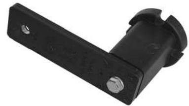
**DE** PX / PX-R Spannelemente sind aus Glasfaserverstärkten Kunststoff mit Metalleinsatz, hervorragend geeignet für korrosive, feuchte Umgebung. Der Spannwinkel kann bis zu 30° in beiden Richtungen gespannt werden. Die Drehmomente, Pos. „b“ und die Hebelstellung „J“ können aus der Tabelle auf der Seite 20 abgelesen werden. Alle PX / PX-R sowie die Kits werden mit Edelstahlschrauben und Muttern (INOX) geliefert. Siehe Seite 18, alle Befestigungssysteme sind auf der Seite 41 zu finden.
