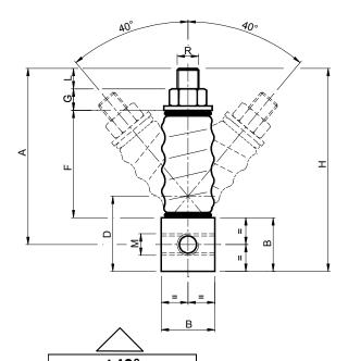
材料 钢。保护套为绝缘橡胶。
