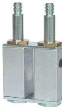
Elément tendeur à double colonne. Les sections carrées sont en aluminium; les jonctions, les colonnes et les bouchons sont en acier zingué. L'élément tendeur ABB a une vis de pré-tension (vis STEI (N) de taille 1 et 2; TE screw (P) de taille 3) pour faciliter les opérations de montage.
