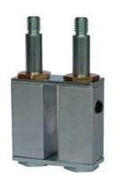
具双柱张紧装置组件。方形主体为铝制;联接部分、方柱和帽为镀锌钢制。轴衬为黄铜制。ABB 张紧装置组件具预加负荷用螺钉(尺寸1和2,STEI(N)螺钉;尺寸3,TE(P)螺钉),以便简化安装操作。
