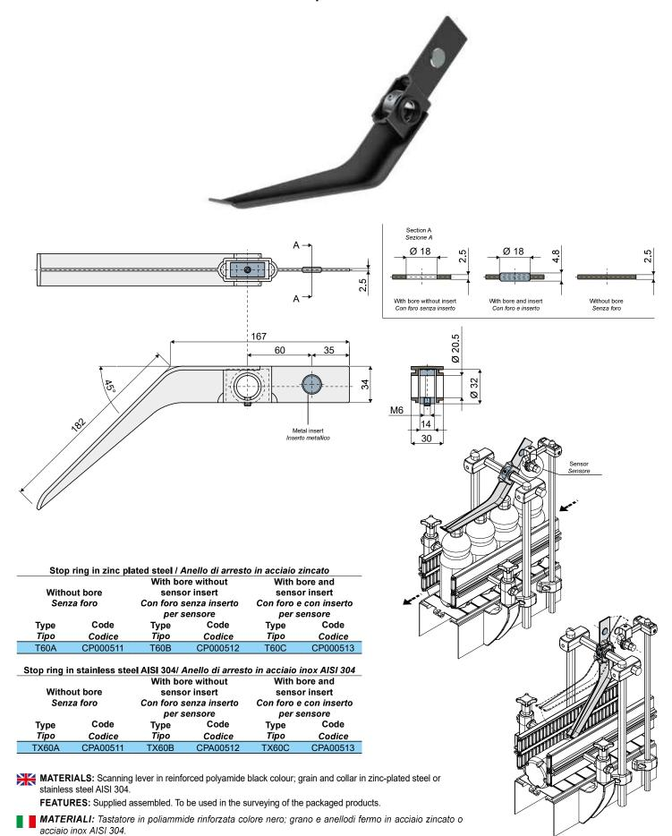
CARATTERISTICHE: Fornito montato. Da utilizzare per il rilevamento meccanico di prodotti confezionati.
