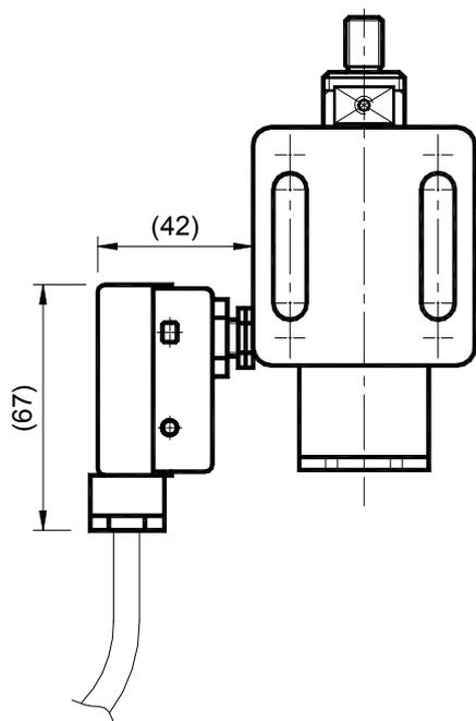
Sur demande, les éléments ARIA/OLIO peuvent être livrés avec une fin de course électrique "E". Les applications avec FCE sont multiples car elles permettent de contrôler le fonctionnement correct des machines et de donner et recevoir des signaux de commande pour les fonctions mécaniques. Ce système est particulièrement indiqué pour garantir l'intégrité de la machine et des opérateurs.
