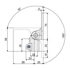
★ Can be used also with square pins 10x10 Utilizzabile anche con perni quadri 10x10
