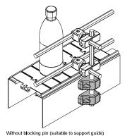
Without blocking pin (suitable to support guide) Senza perno di centraggio (consigliato per il sostengo guide)
