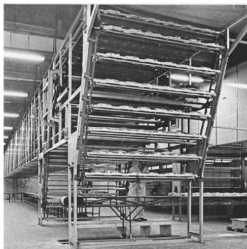
Trasportatore di riposo. Cooling conveyor.
